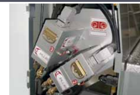
Vista moduli GST/UV interdeck mod. D su torre di essiccazione
