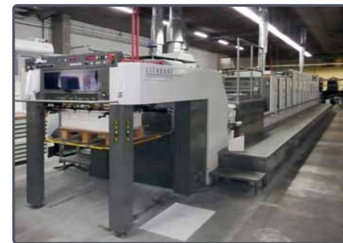
Forni GST/UV + I.R.-A.C. su Komori LSX 629 + 3 L + 2 D.U. + X
