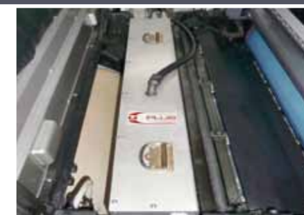
Installazione modulo GST/UV interdeck mod. D
